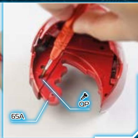
2 - На собранную в предыдущем шаге конструкцию установите ракушку (выпуск 67). Удерживая детали, плотно их соедините: шипы детали (66A) вставляются в отверстия детали (70A), а оси деталей (68C) и (69C) — в отверстия детали (66A). Закрутите два винта LP с внешней стороны детали (70A), чтобы скрепить собранный узел. Закрепите деталь (65A) одним винтом QP.
